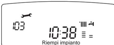
Controle la presión con el hidrómetro y cierre el grifo apenas se alcanzan los 1 - 1,5 bar. Es posible restablecer el funcionamiento del sistema reintegrando agua a través del grifo de llenado de la instalación.
